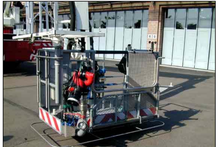
Die Plattformen der Hubretter bieten bei einer hohen Tragfähigkeit viel Platz. Wasserwerfer, Aufnahme für Trage, Strom- und Wasseranschluss gehören zur Grundausstattung.
