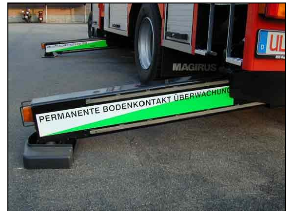
Abstützung Autodrehleiter: Die Räder bleiben auf dem Boden und werden nur entlastet.
