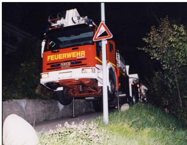
Abstützung Hubretter; Die Räder und Achsen werden abgehoben.
